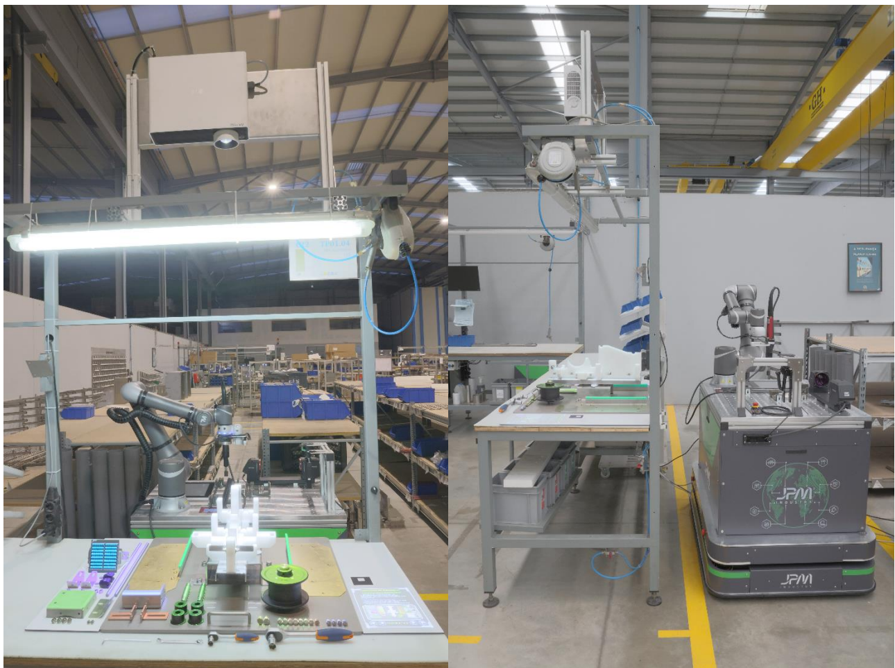
Estação de montagem colaborativa com o manipulador móvel atracado.
